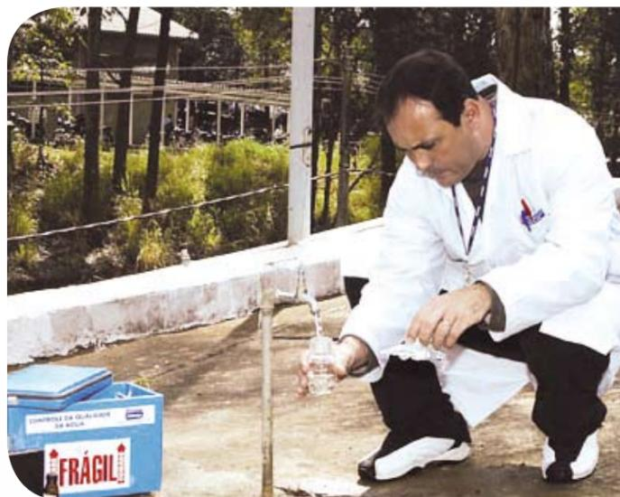
Técnico coleta amostra de água para análise
